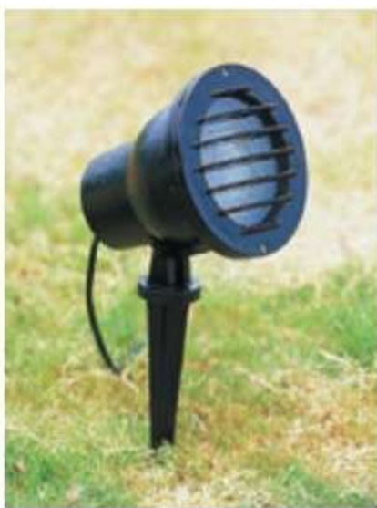
SH-2564F 7850 L218mm W170mm H450mm E27 PAR38 120W珠寶燈泡x1 or LED珠寶型16Wx1 另計 5mm強化玻璃 鋁鑄品 防水矽膠圈 插柱長H230mm 台灣製造
