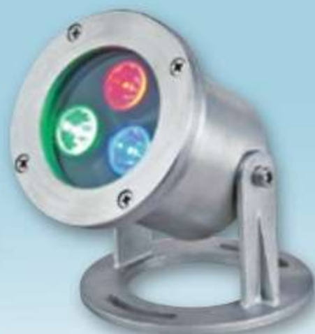
SH-2557A 7250 W90mm H90mm 線長1000mm 附美國普瑞燈珠3粒 1粒120流明 3000K 6500K 藍彩 通過IP68證書 全不鏽鋼 水底用請告知12V 變壓器另計 不放水裡另有110V-220V 12V彩要同步請使用傳統變壓器
