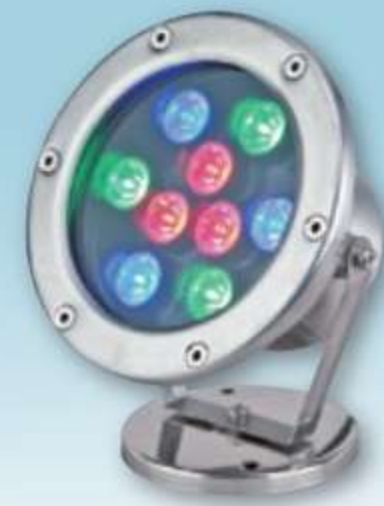
SH-2557C 11600 W160mm H145mm 線長1000mm 附美國普瑞燈珠9粒 1粒120流明 3000K 6500K 藍彩 通過IP68證書 全不鏽鋼 水底用請告知12V 變壓器另計 不放水裡另有110V-22V 12V彩要同步請使用傳統變壓器
