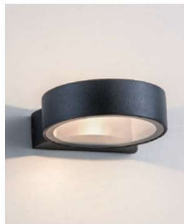
SH-2565D 6450 W135mm H40mm D140mm 附LED 5Wx1 3000K 燈具本體鋁壓鑄粉體烤漆 強化玻璃 IP65
