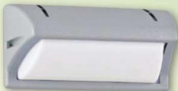
SH-25665 3700 W235mm H120mm D115mm E27x1 另計 鋁合金一體成型 粉體烤漆 PC乳白燈罩 IP54
