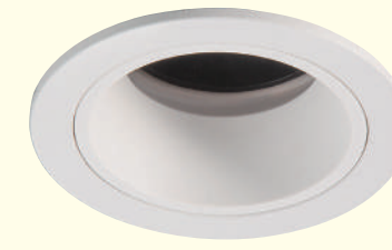
KL-64172 6860 75 mm W89 H120mm Ra ≥ 90 美國原裝 CREE COB 12W 3000K / 4000K 鋁材 AC100-240V 嵌孔 Φ75 mm 深防眩、MR16 模組
